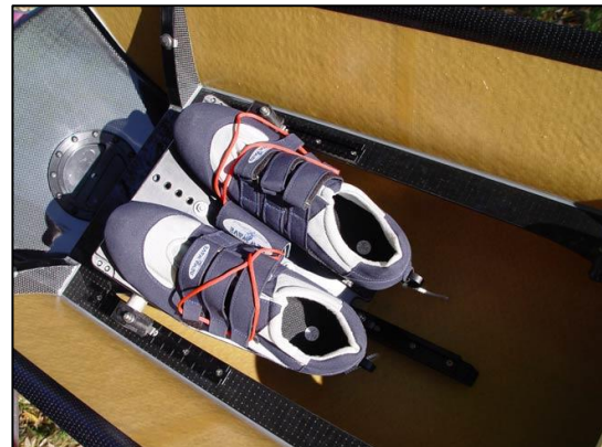
Het voetenbord kan in hoogte worden versteld.
