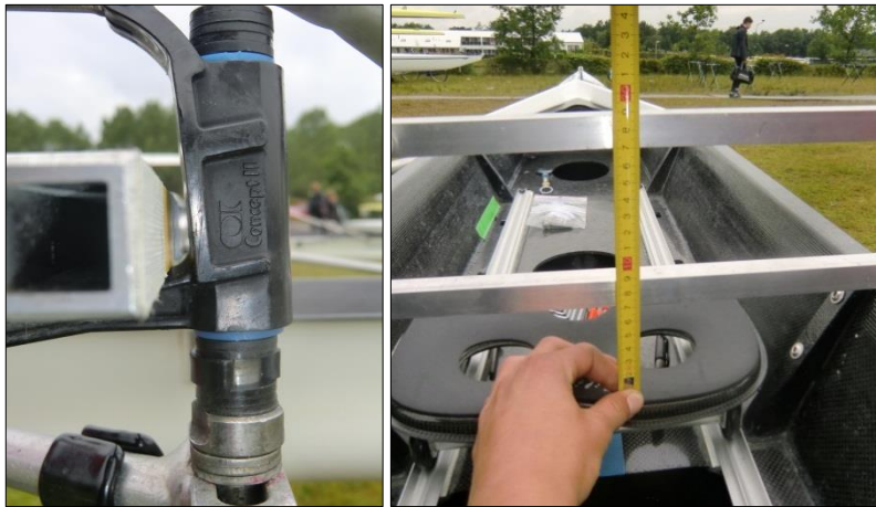
De juiste plek voor de lat op de dol en het meten van de dolhoogte
