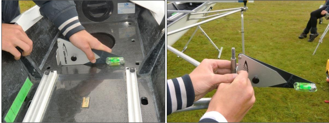
Links het ijken van de dolhoekmeter, rechts het opmeten van de buitenwaartse dolpenhoek
