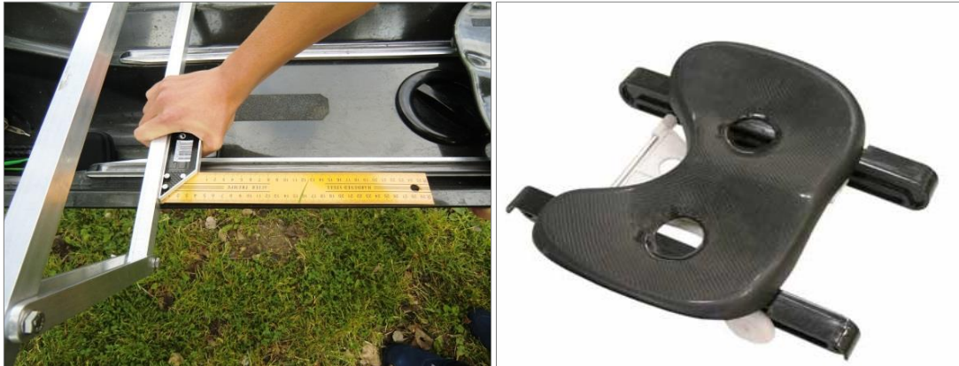
Het meten en markeren van het dolpenhart op de boordrand en het double action bankje
