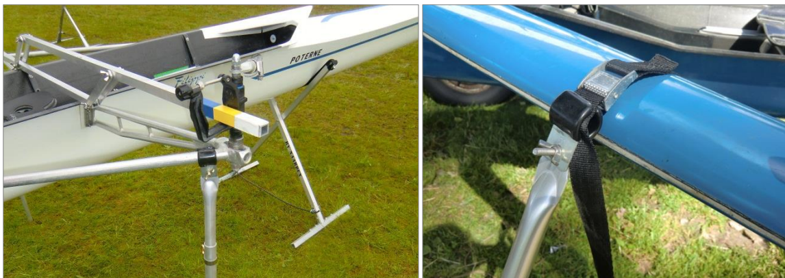
Het gebruik van de fixeerstangen bij een boot met klassieke- en een met vleugelriggers
